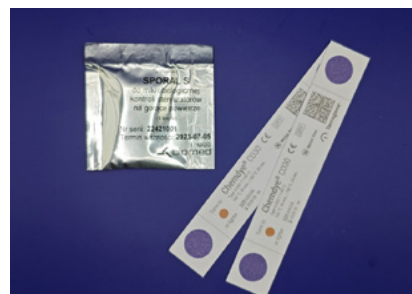
Rys. 1 Wskaźniki sterylizacji, od lewej: Sporal S (wskaźnik mikrobiologiczny) oraz Terragene (wskaźnik fizykochemiczny) służące do oceny skuteczności procesu sterylizacji (fot. Barbara Żołna).
